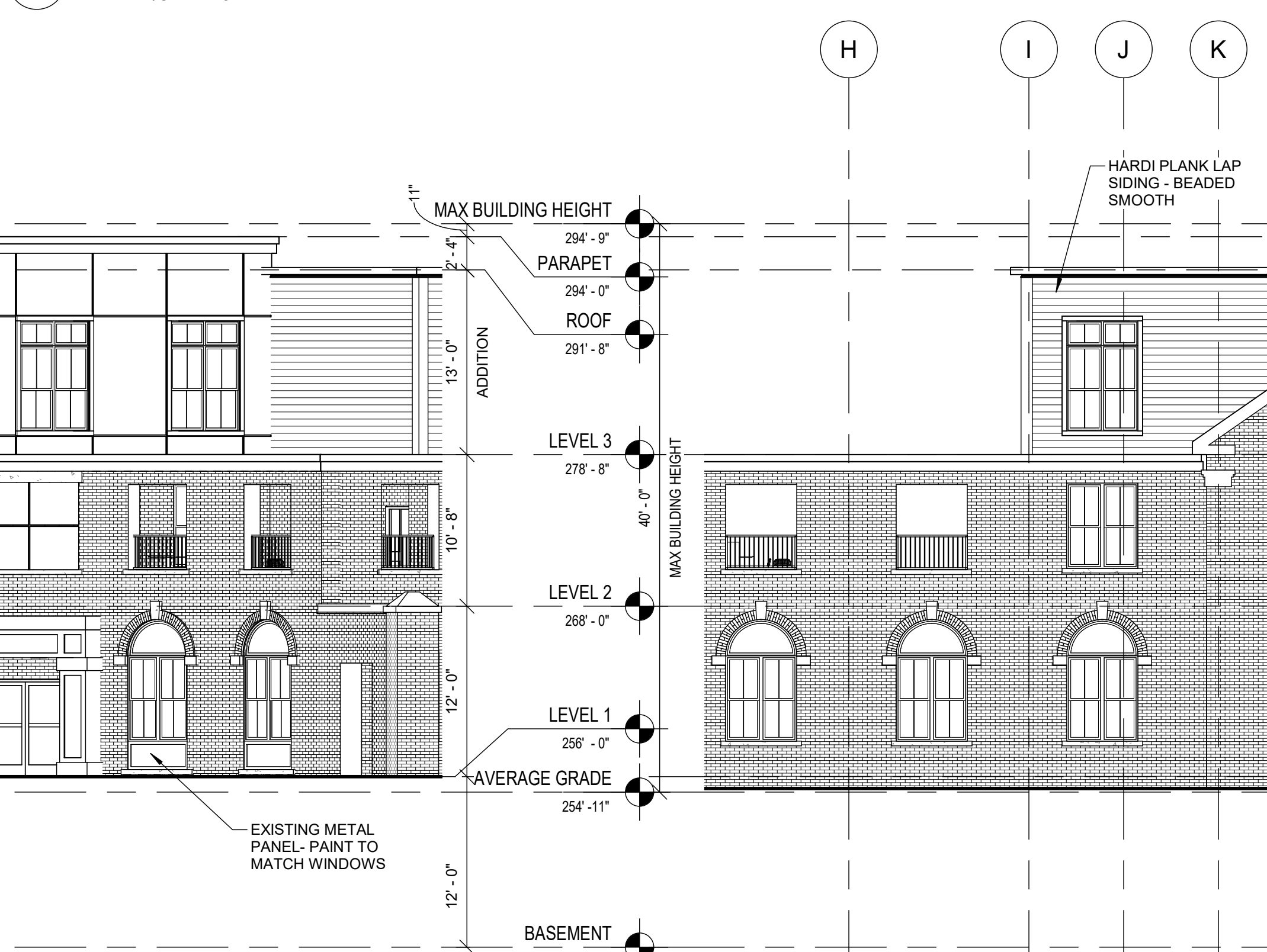
34 EAST ELEVATION - B Scale: 1/8" = 1'-0"
